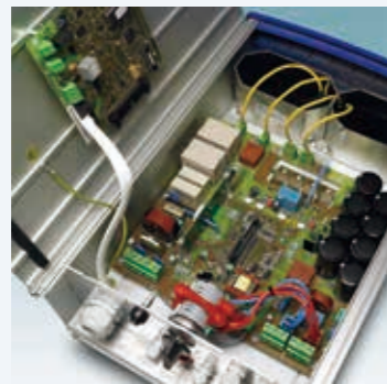
逆变器 PCB 板的板载浪涌保护器
