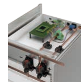
BMS 电池管理系统
