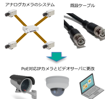
既設ケーブルを再利用して 建屋間ネットワークの構築
