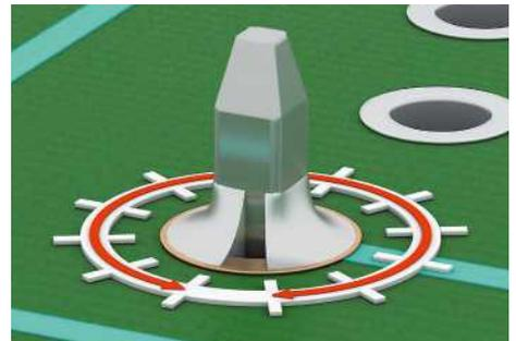
Abb. 64\*: Benetzung Sekundärseite 330° bzw. 92 %
