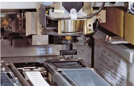
Abb. 49: „Pick“ des Bauteils aus dem Gurt
