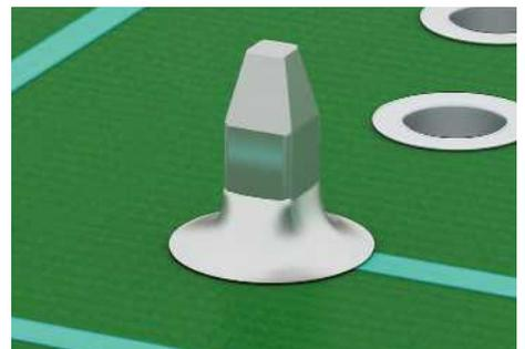
Abb. 66\*: Restring-Abdeckung Sekundärseite ideal vollständig benetzt, minimal 75 %
