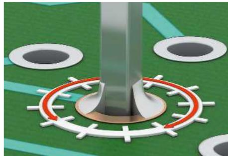
Abb. 63\*: Benetzung Primärseite 270° bzw. 75 %
