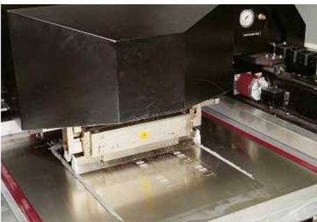
Abb. 40: Rakelsystem zum Lotpastenauftrag
