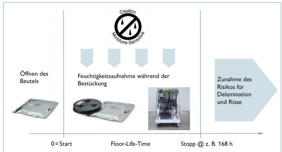
Abb. 27\*: Floor-Life-Time, Beispiel für den Prozess bei Bauelementen mit Level MSL 3
