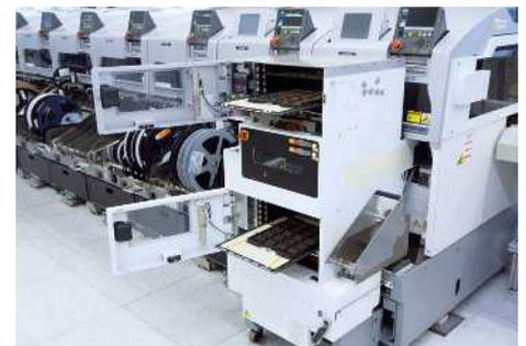
Abb. 57: Tray-Zuführeinheit (Tray-Turm)
