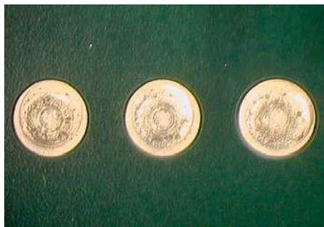
Abb. 71: Beurteilung der Umfangsbenetzung und Lötäugenbenetzung nach IPC nicht definiert
