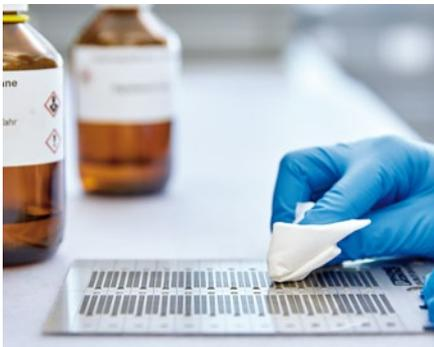
I detergenti aggressivi possono attaccare le siglature e causare lo sbiadimento del materiale, l'illeggibilità delle scritte o la rottura delle stesse. Pertanto, i materiali di siglatura devono avere un'elevata resistenza chimica.
