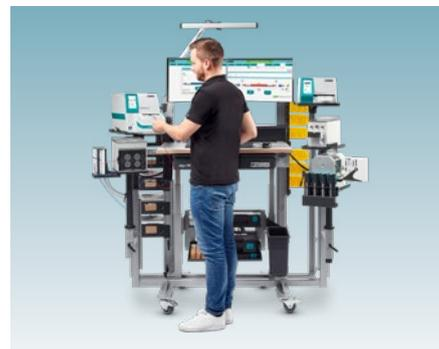
Il sistema di assistenza operatore clipx WIRE assist consente un'elaborazione dei cavi efficiente. Combina il sistema basato su software con i tuoi sistemi di stampa per una preparazione dei cavi facile ed ergonomica.
