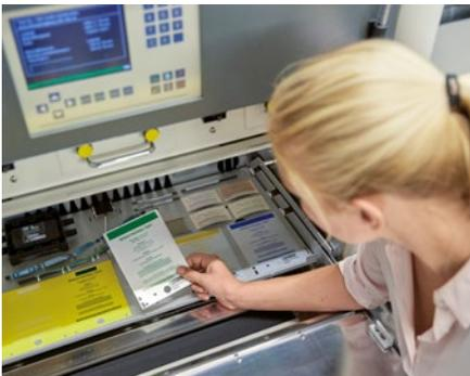
Per simulare un utilizzo di più anni in ambienti esterni, i materiali di marcatura nel nostro laboratorio vengono esposti ciclicamente a radiazioni UV e all'umidità e sono quindi testati secondo lo standard DIN EN ISO 4892-2.
