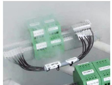
In alcune applicazioni, le siglature devono resistere all'atmosfera salina. Per garantire queste caratteristiche, la resistenza dei materiali viene testata in atmosfera corrosiva mediante nebbia salina.
