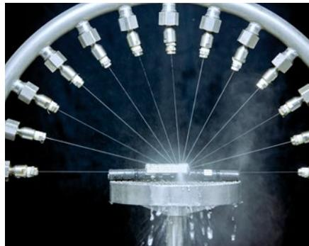
Il grado di protezione IP delle siglature viene determinato con l'ausilio di un test con ugello d'acqua ed esprime il grado di protezione che un materiale ha contro la penetrazione di corpi estranei e la sua impermeabilità all'umidità.
