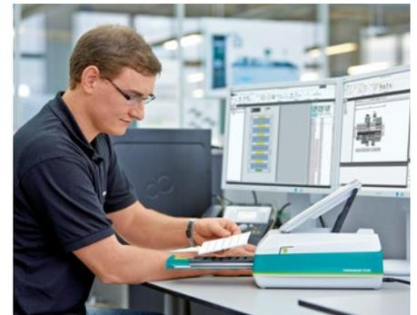
In caso di utilizzo fisso, THERMOMARK PRIME può essere facilmente comandato e gestito tramite il software MARKING system. Per la siglatura sul campo, la stampante mobile è dotata di software integrato.
