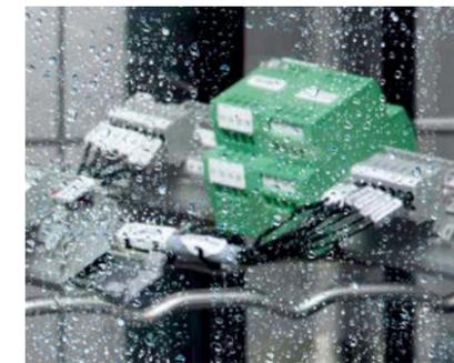
耐腐蚀测试, 符合DIN 50018标准
