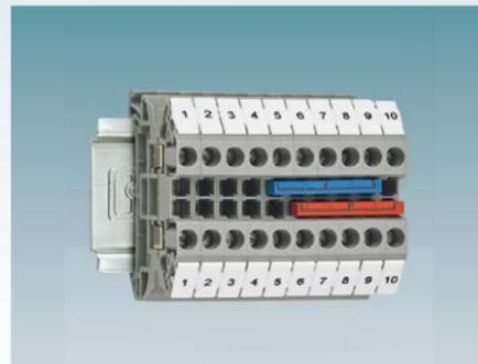
CLIPLINE complete系统的UT螺钉连接式接线端子符合严格的要求，适用于各种应用领域。端子采用了根据“缝隙原理”的螺钉自锁技术，拧紧端子后，可有效地防止螺钉松脱。
