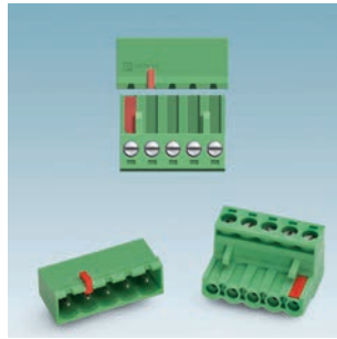
① プラグとソケットにそれぞれのコーディングキーを取り付けます。同じ極に取り付けると嵌合しません。
