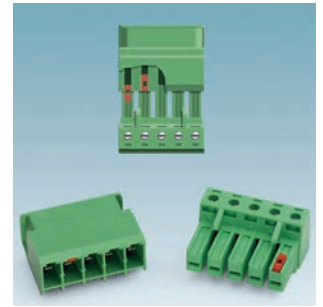
③ プラグとソケットに同型式のコーディングキーを取り付けます。同じ極に取り付けると嵌合しません。
