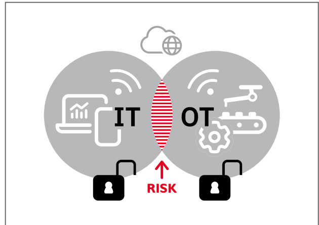
Neben lukrativen Potenzialen sorgt die zunehmende Vernetzung des OT-Bereichs für erhebliche Sicherheitslücken in der IT und OT. Ein integriertes Handeln der beiden Bereiche ist gefordert.
