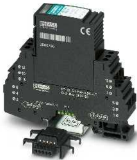
Scaricatore a innesto con connessione a vite per cinque conduttori, con potenziale di riferimento in comune
