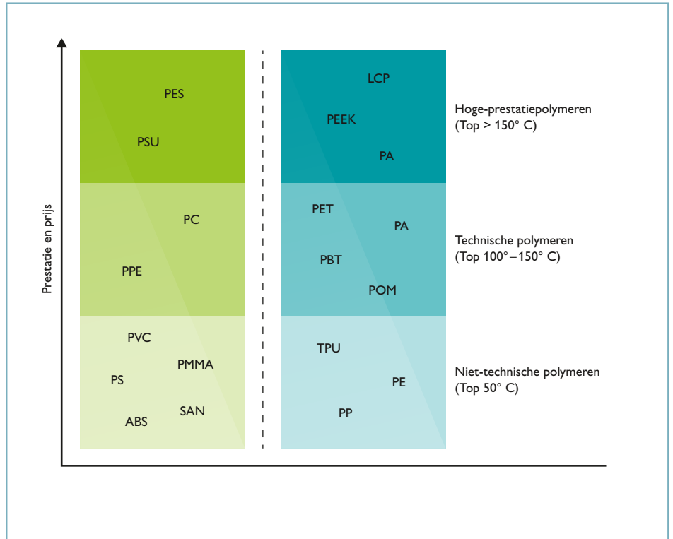
Afb. 57: Rangschikking van diverse thermoplasten naar prestatie en prijs
