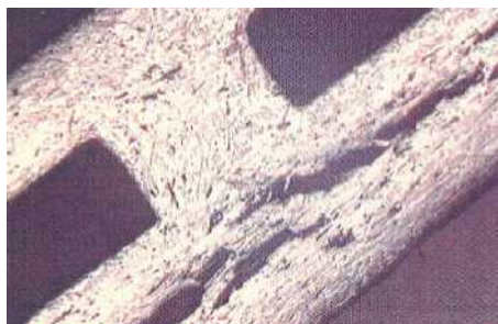
Afb. 30: Niet doorstaan level – schadebeeld scheurvorming
