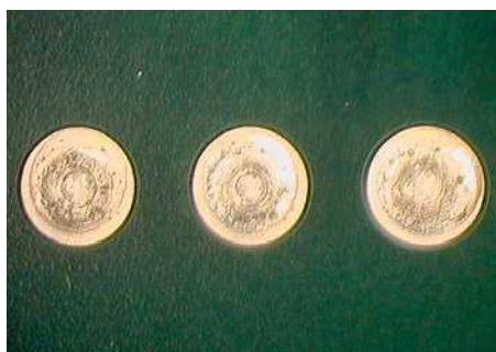
Afb. 71: Beoordeling van de vloeïng rondom en de soldeeroogvloeïng volgens IPC niet gedefinieerd
