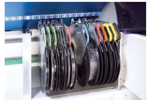
Afb. 54: Beperkte ruimte op de feeder-tafel
