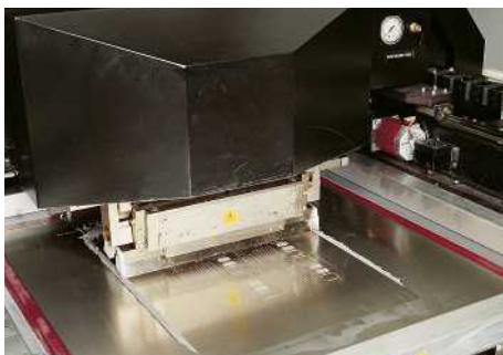
Afb. 40: Rakelsysteem voor het aanbrengen van soldeerpasta
