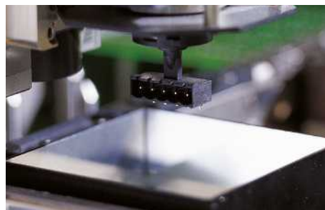
Afb. 50: Cameraregistratie voor uitmeting van het component
