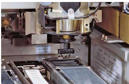
Afb. 49: „pick“ van het component uit de rol
