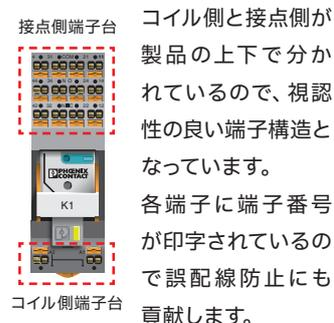
コイル側と接点側が製品の上下で分かれているので、視認性の良い端子構造となっています。各端子に端子番号が印字されているので誤配線防止にも貢献します。
