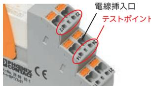
電線挿入口の下に配置されているテストポイントで導通確認が可能。コイル側端子台、接点側端子台のすべての電線挿入口に付いています。
