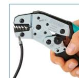
Dieser weit verbreitete und universelle Crimpzangentyp basiert auf dem Scherenprinzip und ist mit Gesenken für unterschiedliche Kontaktarten erhältlich. Jeder Querschnitt hat hier sein eigenes Gesenke. So muss explizit auf die korrekte Positionierung geachtet werden.
