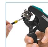
Eine Untergruppe der selbststellenden Crimpzangen ist mit einem drehbaren Gesenke ausgestattet. Die Leitereinführung kann seitlich oder frontal erfolgen. So kann auch in beengten Arbeitsbereichen komfortabel gecrimpt werden.
