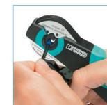
Die selbststellenden Crimpwerkzeuge besitzen nur einen Einlegeschatz, der sich bei der Betätigung eigenständig auf den zu verarbeitenden Querschnitt einstellt. Darauf basierend eignen sie sich auch optimal für andere Leiterstandards (JIS/AWG) und für TWIN-Aderendhülsen. Die besondere Mechanik ermöglicht quadratische und hexagonale Crimpformen.
