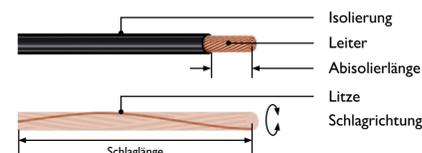
Die Schlaglänge stellt ein Maß für die Formstabilität des Leiters dar. Je geringer die Schlaglänge, desto steifer und kompakter ist der Leiter. Ebenso erhöht dies den Außendurchmesser.
