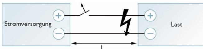
Prinzipdarstellung der maximalen Leitungslänge
