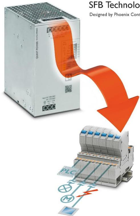
Um Standard-Leitungsschutzschalter magnetisch und damit schnell auslösen zu können, liefert die SFB-Technology den bis zu 6-fachen Nennstrom für 15 ms.
