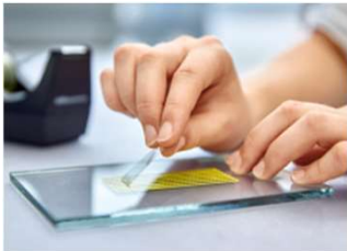
Grid test DIN EN ISO 2409
