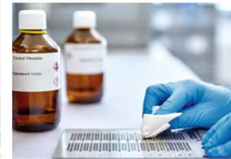
Wear and wipe resistance DIN EN 61010-1 | DIN EN 62208
