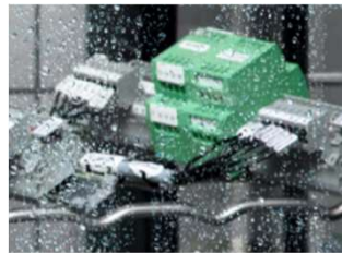
Corrosion test DIN 50018
