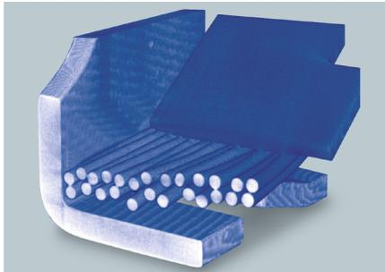
Röntgenaufnahme des korrekten Leitersitzes in einer Federkraftklemme
