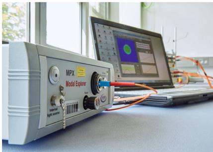
Verhindern von Dämpfungen und Reflexionen durch Stirnflächenprüfung bei LWL-Leitungen
