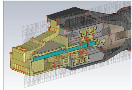
Simulation des Hochfrequenzverhaltens bei RJ45-Steckverbindern
