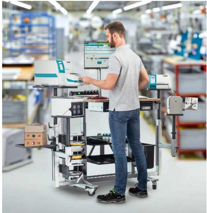
Ergonomische und softwaregestützte Leiter- und Kabelverarbeitung
