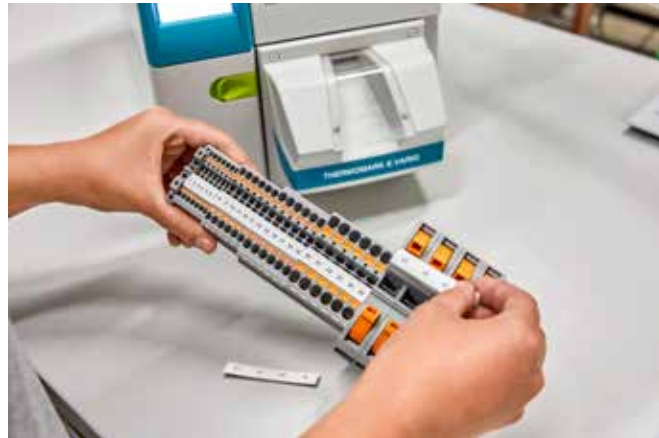
Opmærkning af hele klemrækken med blot to materialer
