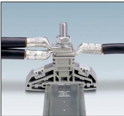
So lassen sich an einer Einbolzenklemme mehr als zwei Leiter anschließen. Die Kontaktübergabe findet direkt zwischen den Kabelschuhen statt.
