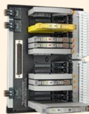
Triagem de sinal Universal de I/O Marcação de I/O VIP
