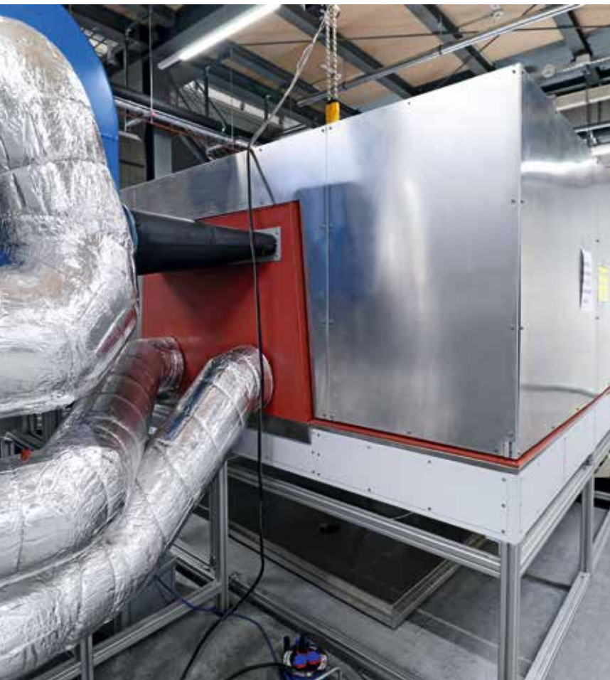
T-shocker模拟 温度下降 常量变化范围自 -40°C至+75°C
