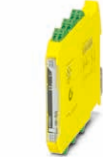
通过IEC 61508的SIL 3认证， 1路常开安输出触点（备选）， 1路诊断电流通路
