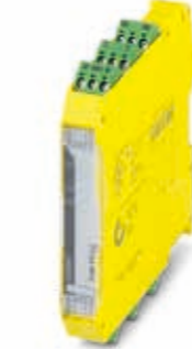
通过IEC 61508的SIL 3认证， 2路常开安输出触点， 1路诊断电流通路，宽域输入
