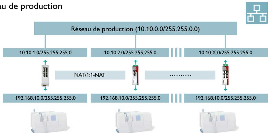
Connexion de la machine avec routeurs NAT et de sécurité
