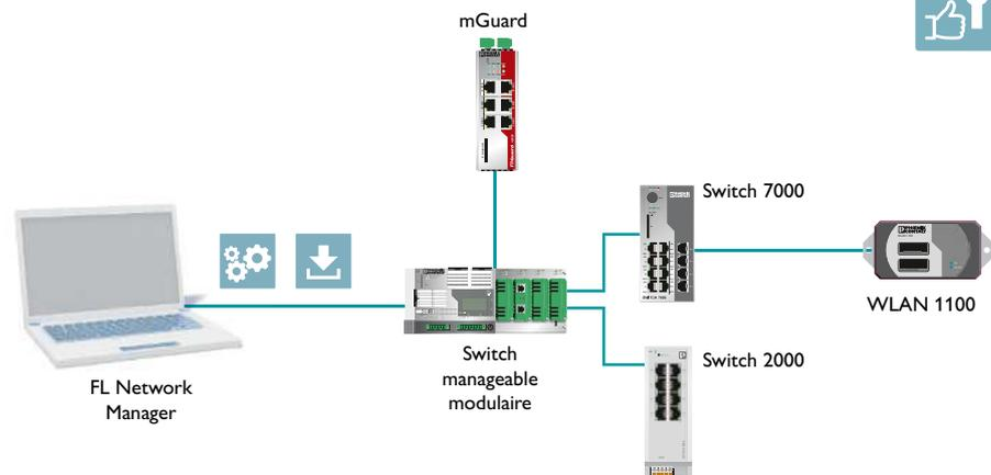
Configuration et mise en service du réseau avec le logiciel FL Network Manager
