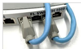
制御盤の扉に押されて、強く曲げられたケーブル
