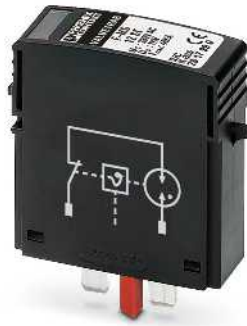
适用于240/415V的TN以及TT系统的间隙型器件， 只能应用于N-PE之间，可双向安装
