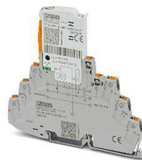
3线, 带公共参考电位, 3/6通过气体放电管接地, 插拔式
