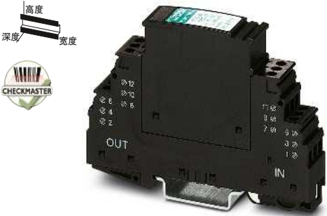
电涌保护插头，螺钉连接，可用于共用参考电位的五根信号线的保护
