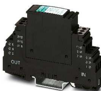
电涌保护插头, 螺钉连接, 可用于共用参考电位的五根信号线的保护
