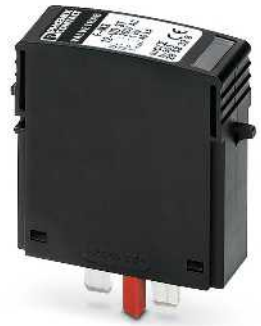
适用于240/415V的TN以及TT系统的间隙型器件， 只能应用于N-PE之间，可双向安装
