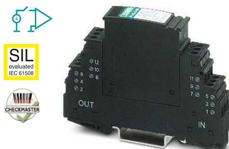
4线, 带公共参考电位, 9/10直接接地, 例如, 用于开关量信号
