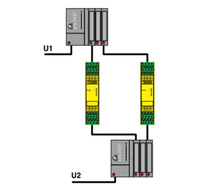
带故障诊断输出功能, 实现两个系统之间可靠的信号交换。
