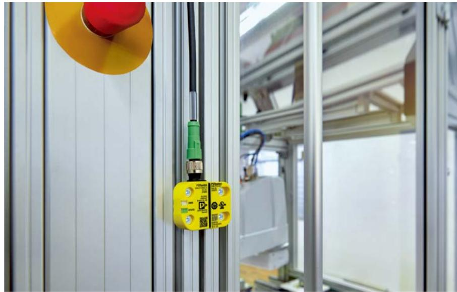
紧凑的PSRswitch是一款电子编码安全开关，可实现灵活可靠的安全门和位置监控。该设备集成了RFID和智能技术，可达到EN ISO 13849和EN ISO 14119标准规定的最高等级的防篡改保护和防护。
