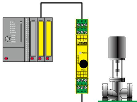
一个来自现场的安全PLC输出电气隔离的实例。
