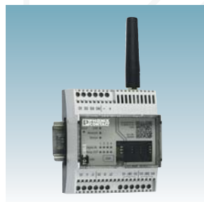
SMS relé s analogovými a digi- tálními vstupy a výstupy
