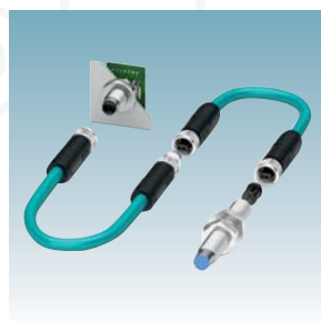
M8 konektory pro Single Pair Ethernet IP67, přenos dat až 1 Gb/s na vzdálenost až 1 000 m
