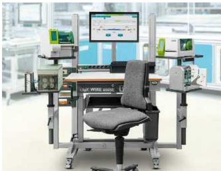
Beste Ergonomie durch einen höhenverstellbaren Werkstisch sowie optimale Positionierung der Werkzeugautomaten und Beschriftungsgeräte.
