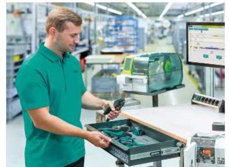
Kurze Such- und Zugriffszeiten durch strukturierte Anordnung und Positionierung der Werkzeuge und Hilfsmittel unter Anwendung des 5S-Prinzips.
