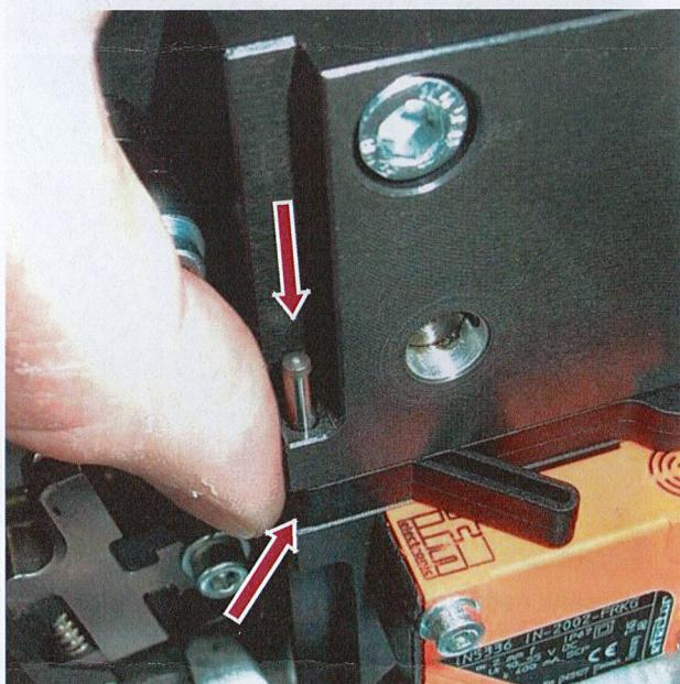
Achse einsetzen und in der Bohrung des Starthebels zentrieren.
