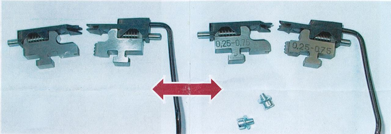
Wechsel des Standard Gesenkes  $0,5 - 2,5 \text{ mm}^2$  mit  $0,25 - 0,75 \text{ mm}^2$
