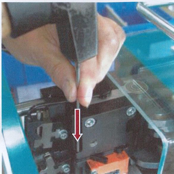
Achse des Starthebels entfernen.
