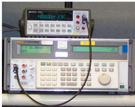
Abbildung 7: Messaufbau Multimeter - Kalibrator
