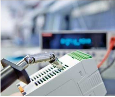
Abb. 65: Prüfung auf mechanische Dichtigkeit
