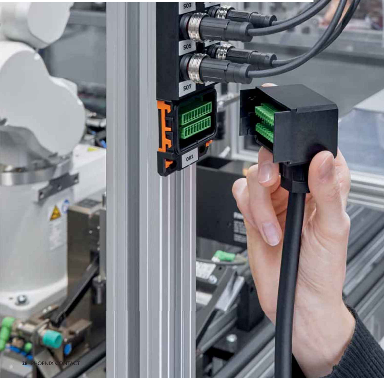
Rýchla montáž krytu konektora bez použitia nástroja.
