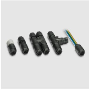
산업용 전원 분배는 시간 소모적이거나 복잡할 필요가 없습니다. 최대 690 V/40 A 용량을 제공하는 견고한 IP68/IP69K QPD 설치 시스템을 사용하십시오. 검증된 QUICKON IDC 연결 덕분에 피복 분리 또는 특수 공구를 사용할 필요 없이 최대 5 x 6.0 mm<sup>2</sup>의 케이블을 빠르고 쉽게 연결할 수 있습니다. 유연한 분배 솔루션을 만들기 위해 고정 연결 또는 플러그타입 연결을 선택할 수 있습니다. 또한 장치를 열지 않고도 쉽게 장치 연결을 구현할 수 있습니다. 이는 외부 영향으로부터 정교한 전자 장치를 보호할 수 있음을 의미합니다.
