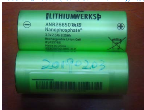
锂离子电池组内部组成元件电池芯 ANR26650M1-B ( 2.5Ah ), 报告编号 20190203 the cell in the Lithium battery module ANR26650M1-B(2.5Ah), test report 20190203
