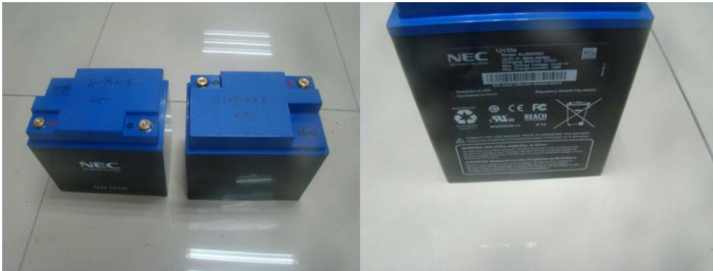
锂离子电池组 PSL000002 ( 13.2V 35Ah 462Wh ) 报告编号 20190203 (Lithium battery module PSL000002(13.2V 35Ah 462Wh), Test report: 20190203)
