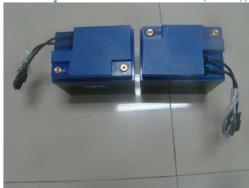
锂离子电池组 PSL000003 ( 13.2V 35Ah 462Wh ) 报告编号 20190201 Lithium battery module PSL000003(13.2V 35Ah 462Wh) test report: 20190201
