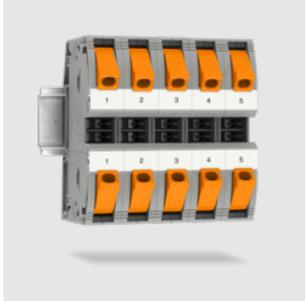
피닉스컨택트 고전류 단자대는 최대 1,500 V의 정격 전압에 맞게 설계되었습니다. 이 단자대를 DIN 레일에 스냅하거나 직접 마운팅을 통해 마운팅 플레이트에 스크류로 고정할 수 있습니다. 해당 픽-오프 단자를 통해 손쉬운 피드-인 및 전위 분배가 가능합니다. 이 단자대는 최대 240 mm<sup>2</sup>의 여러 케이블 사이즈로 제공됩니다.
