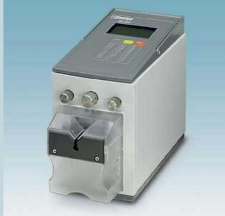
Der Abisolierautomat WF 1000 ermöglicht das automatische Abisolieren mit der Möglichkeit des Teilabzugs der Isolation von Leitern bis 6 mm<sup>2</sup> oder Leitungen bis 6 mm Ø. Die individuelle Einstellung der Abisoliermaße geschieht über Drehknöpfe und wird visuell auf dem Display angezeigt.
