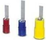
Die isolierten Flachstiftkabelschuhe mit Kunststoffkragen zeichnen sich aus durch „Easy Entry“: einfache und sichere Leitereinführung, hartgelötete Crimpzone für höchste Auszugskräfte, elektrolytische Verzinnung als Korrosionsschutz und Halogenfreiheit.
