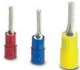
Die isolierten Stiftkabelschuhe mit Kunststoffkragen zeichnen sich aus durch „Easy Entry“: einfache und sichere Leitereinführung, hartgelötete Quetschzone für höchste Auszugskräfte, elektrolytische Verzinnung und Halogenfreiheit.
