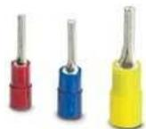
Die isolierten Stiftkabelschuhe C-PCEI... sind mit einer zusätzlichen Metallhülse für den Isolationscrimp ausgestattet. Leiter und Isolation werden in Kombination gecrimpt, wodurch erhöhte Vibrationssicherheit und Zugfestigkeit realisiert werden.
