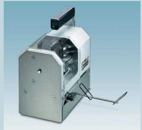
Der Abisolier- und Crimpautomat CF 3000-2,5 verarbeitet Aderendhülsen in Bandwarenausführung mit Isolierkrägen nach DIN 46228-4. Das Gerät kann Leiter im Querschnittsbereich von 0,25 bis 2,5 mm<sup>2</sup> in einem Arbeitsgang abisolieren und mit Aderendhülsen versehen. Die Umrüstung des Automaten auf unterschiedliche Querschnitte ist innerhalb einer Minute möglich.
