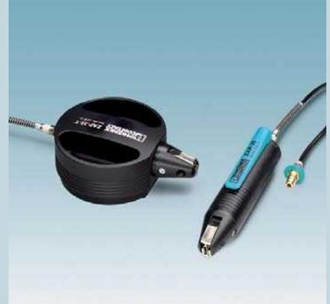
Die ZAP-Presszangen sind druckluftbetriebene Werkzeuge für Aderendhülsen im Querschnittsbereich von 0,25 bis 10 mm<sup>2</sup>. Die Auslösung des Pressvorgangs erfolgt variantenabhängig über ein Fußventil oder einen Handauslöser. Für den schnellen Zugriff auf die Aderendhülsen sorgen zwei integrierte Aufnahmebehälter.
