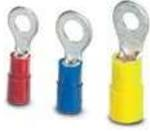
Die isolierten Ringkabelschuhe sind mit Kunststoffhülsen mit dem Easy-Entry-System ausgestattet. Die Hülsen laufen konisch zu und ermöglichen so ein einfaches und korrektes Einführen des Leiters. Der hartgelötete Crimpbereich gewährleistet beste mechanische Eigenschaften und erlaubt horizontale oder auch vertikale Crimpungen.
