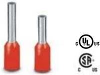
Die Aderendhülsen mit Kunststoffhülse bestehen aus weichem Elektrolytkupfer mit galvanischer Verzinnung. Die Isolationssicherheit bei eng aneinanderliegenden Anschlüssen wird erhöht und das Abspülen von Drähten verhindert. Der konisch gestaltete Isolierkragen „Easy Entry“ garantiert ein einfaches und korrektes Einführen des Leiters.
