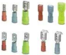
Die isolierten Flachsteckhülsen sind mit dem Easy-Entry-System ausgestattet. Die Hülsen laufen konisch zu und ermöglichen so ein einfaches und korrektes Einführen des Leiters. Eine zusätzliche Metallhülse gewährleistet beste mechanische und elektrische Eigenschaften und erlaubt horizontale oder auch vertikale Crimpungen.
