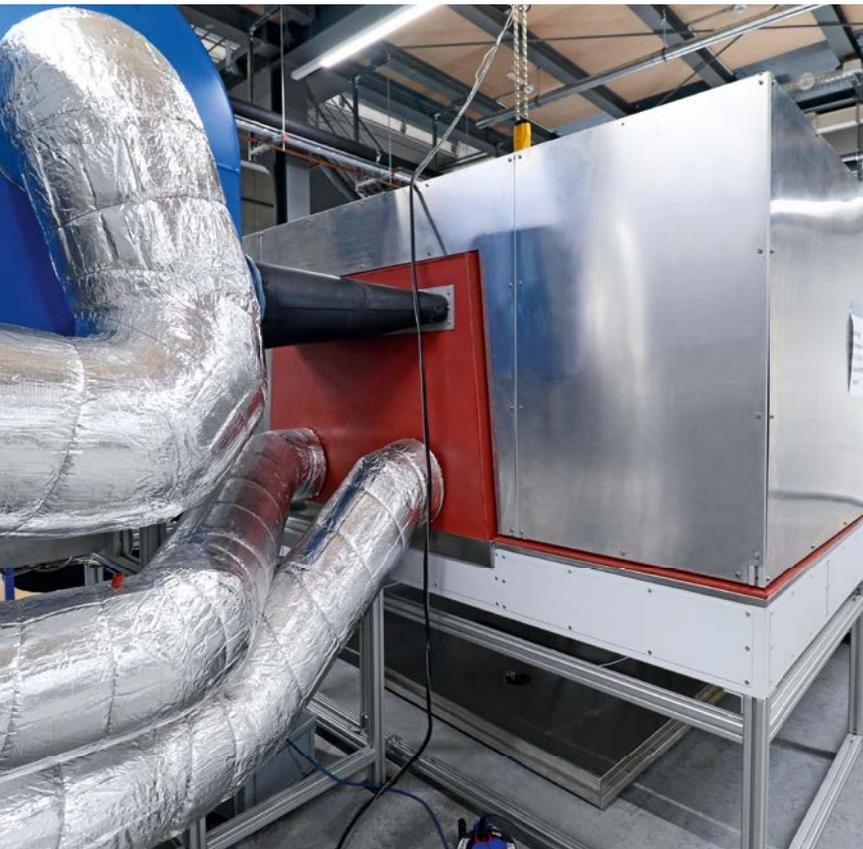
Im T-Schocker werden Temperaturstürze simuliert – in ständigem Wechsel von -40 °C bis +75 °C
