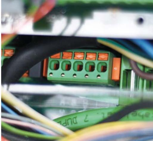
Die SKEDD-Anschlusstechnik ermöglicht lötfreie Anschlüsse
