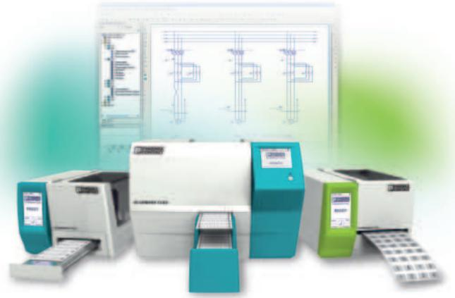
1대의 프린터로 단자대, 전선, 장치, 기판 마킹 및 경고 라벨을 제작할 수 있습니다. 라벨은 산업 분야에서 사용할 수 있도록 뛰어난 내자외선, 내유, 내화학(에탄올, 노말헥산 등) 성질을 가지고 있으며, 컨트롤 패널 내의 마킹, 경고 마크 또는 케이블 마킹 등과 같은 다양한 용도 및 장소에 사용할 수 있습니다. 인쇄 속도가 빠르고 필요한 수량만큼 인쇄 가능하기 때문에 불필요한 부자재를 발생시키지 않아 시간과 비용을 절약할 수 있습니다.
