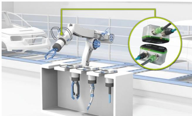
Werkzeugwechsel bei Industrie-robotern
