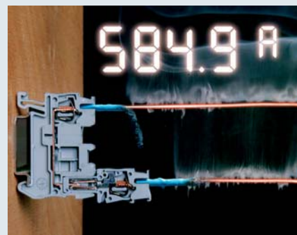
プラグ式端子台でのテストの様子
