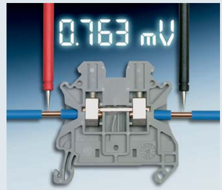
ねじ式端子台での電圧降下測定例
