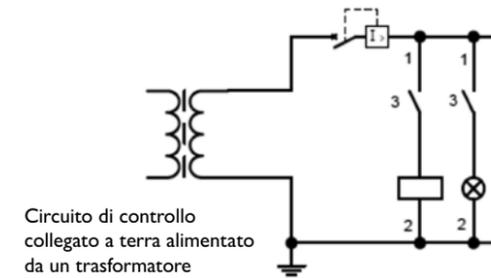
Circuito di controllo collegato a terra alimentato da un trasformatore
