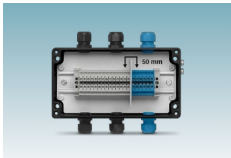
Folga através da placa divisória entre circuitos intrinsecamente seguros e outros circuitos
