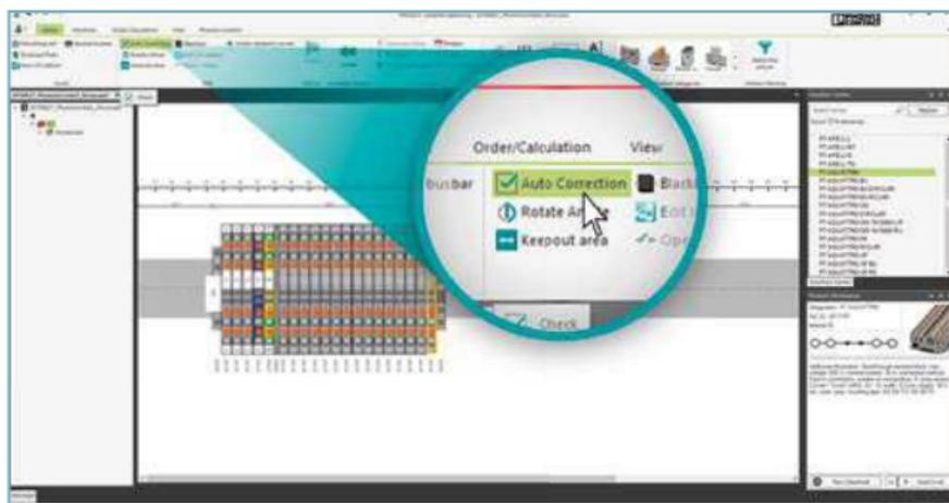
Starten Sie manuell die Autokorrektur, indem Sie die Checkbox „Auto Correction“ anklicken, damit erneut das minimal notwendige Zubehör hinzugefügt wird.
