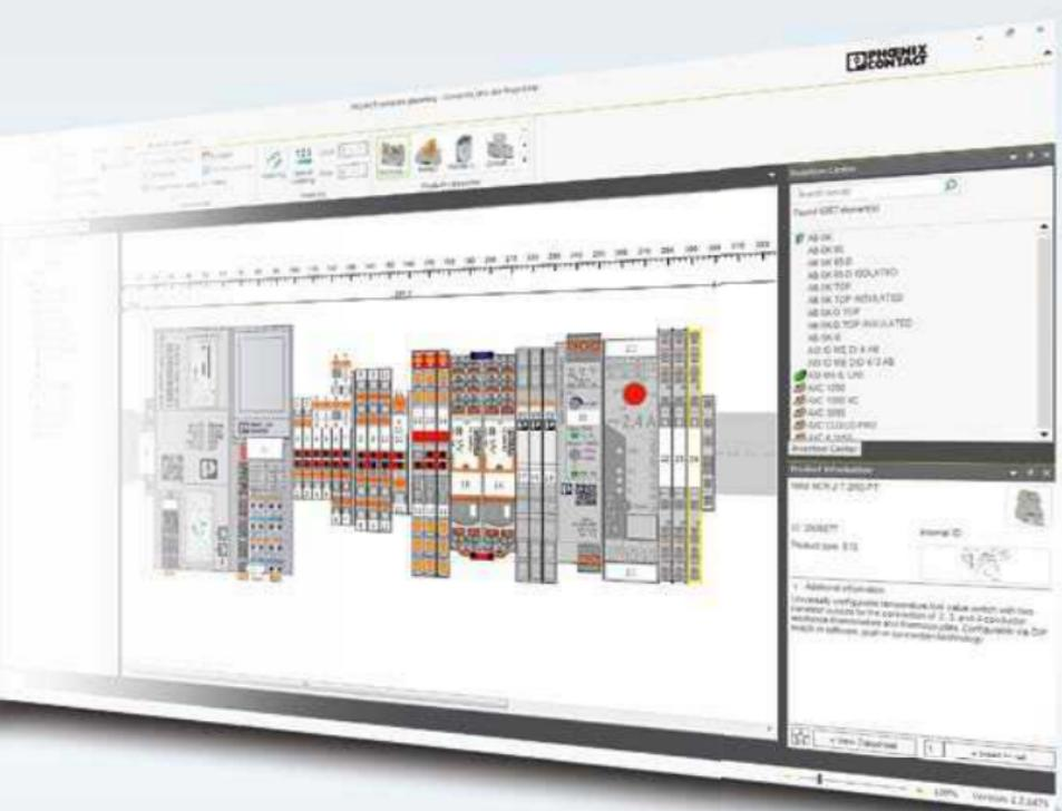
In PROJECT complete können Sie automatisch selektierte Klemmen ersetzen und Zubehör hinzufügen. Nach der Bearbeitung der Klemmenleiste werden die Änderungen nach E3.series exportiert.
