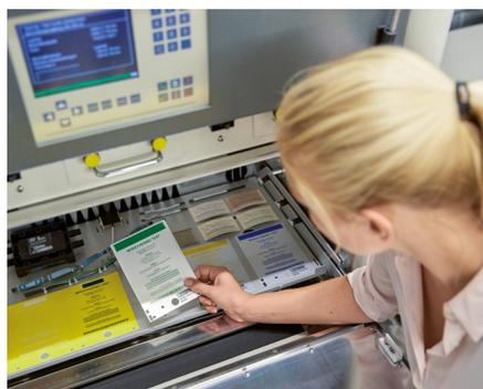
Pour simuler une installation en extérieur pendant plusieurs années, nous soumettons les matériels de repérage à des contraintes cycliques liées au rayonnement UV et à l'humidité dans notre laboratoire pour les tester conformément à la norme DIN EN ISO 4892-2.
