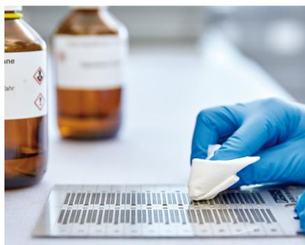
Les produits de nettoyage agressifs peuvent attaquer les repérages et provoquer une décoloration du matériau, rendre l'écriture illisible ou entraîner une rupture fragile. Les matériels de repérage doivent donc présenter une résistance chimique élevée.
