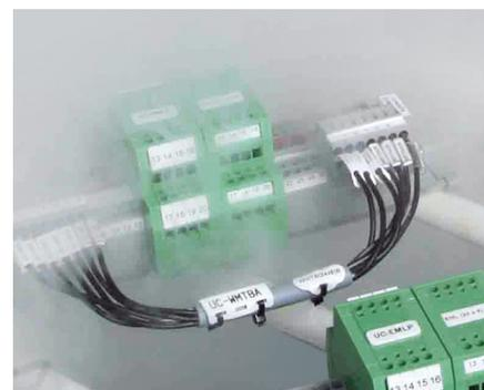
Dans certains domaines d'application, les marquages doivent résister à une atmosphère saline. Pour le garantir, la résistance des matériels est testée dans une atmosphère rendue corrosive par brouillard salin.
