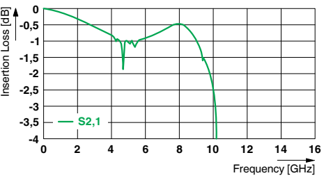
FS 0,635/...-FV-R-10,0搭配FS 0,635/...-MV-R- 9,0，差分对，堆叠高度16.6 mm
