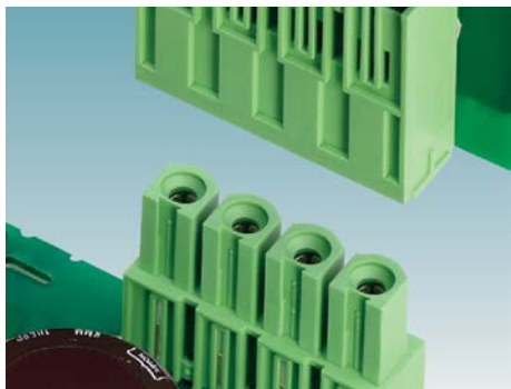
PC 16 插拔式连接器，针距为10.16 mm，每个触点电流最高为76 A，适用于波峰焊。
