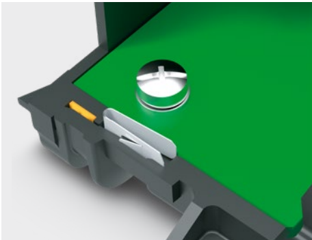
内置互锁机构，防止PCB意外松脱。
