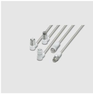
식품 산업에서는 위생 안전성이 최우선 과제입니다. 케이블링은 침윤성 세척제 및 세척 프로세스를 견뎌야 합니다. 워시다운(Washdown) 설계의 M8 및 M12 커넥터에는 플라스틱 날이 장착되어 있으며 표면이 유독 매끄럽고 세척이 용이합니다. 방말 영역의 특수 요구 사항에 맞게 플라스틱 소재를 선택하고 케이블을 최적화합니다. 제품 접촉 영역에서 사용하기 위해 위생적 설계의 M12 커넥터에는 표면이 매우 매끄러운 스테인리스 스틸 1.4404로 제작된 날이 있습니다. 이로 인해 음식을 찌꺼기가 가라앉는 것이 불가능해집니다. 높은 수준의 전자기 간섭을 받는 영역의 경우 차폐 버전을 사용할 수 있습니다.
