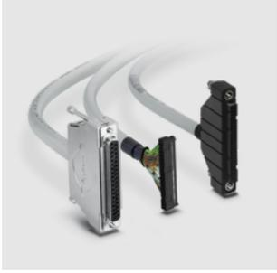
D-SUB 또는 FLK 커넥터가 있는 시스템 케이블은 자동화 장치와 터미네이션 보드 간의 빠르고 오류 없는 1:1 연결입니다. 다양한 핀 수를 가진 사전 조립된 시스템 중에서 선택하십시오. 이러한 케이블은 단일 전선과 핀 또는 소켓 스트립으로 연결할 수 있습니다. 고객을 위한 서비스: 표준 길이인 0.5 m 에서 10 m 의 표준길이 및 고객이 지정한 길이의 시스템 케이블을 공급할 수 있습니다.
