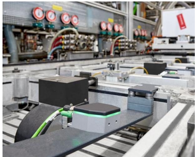
*An jedem Werkstückträger ist ein NearFi-Koppler zur kontaktlosen Datenübertragung montiert*
