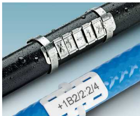
线缆标记套环，配合扎带使用，无需考虑线缆直径。标识区域大，提供足够的标记空间。
