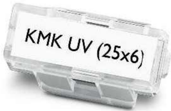
配合插入式标识使用，标记范围25 x 6 mm，用于线径6 mm以上的线缆
