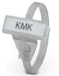
配合插入式标识使用，标记范围29 x 8 mm，用于线径10 mm以上的线缆
