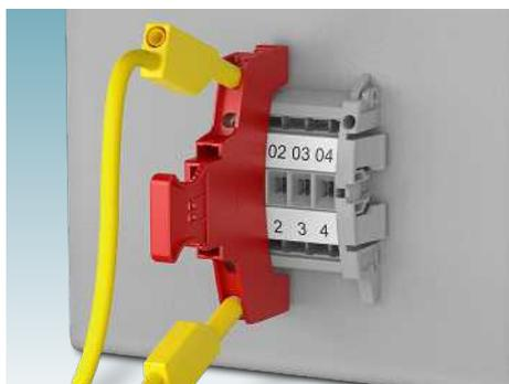
Pour les opérations d'essai spéciales, vous disposez de connecteurs d'entretien avec des alvéoles pour fiche test de 4 mm, avec des nombres de pôles différents. Les alvéoles pour fiche test permettent la mise en boucle avec des câbles de test de sécurité, d'appareils de mesure par exemple.
