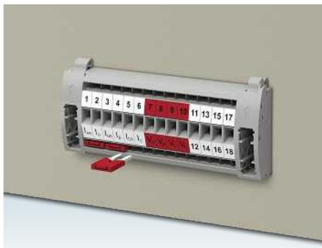
Le court-circuitage du convertisseur à action avancée automatique est réalisé avec des ponts enfichables standard dans l'embase pour prise de test. L'emplacement des ponts de courts-circuits est nettement visible à l'extérieur de l'armoire électrique.
